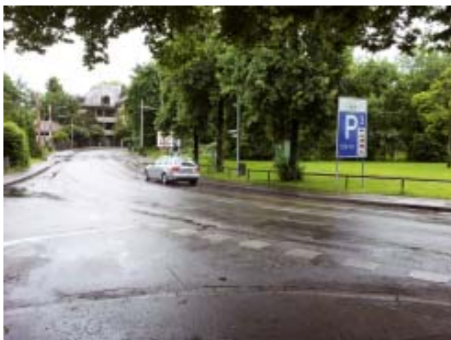
Eine Brücke über die abgesenkten Bahngleise könnte westlich des bestehenden Bahnübergangs am Langenweg über eine Trasse erfolgen, die über die grüne Wiese und auf der anderen Seite über den Busparkplatz führt, so dass während der Bauzeit der Bahnübergang weiterhin genutzt werden könnte.
